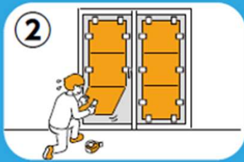
窓ガラスの内側にダンボールを貼り補強
