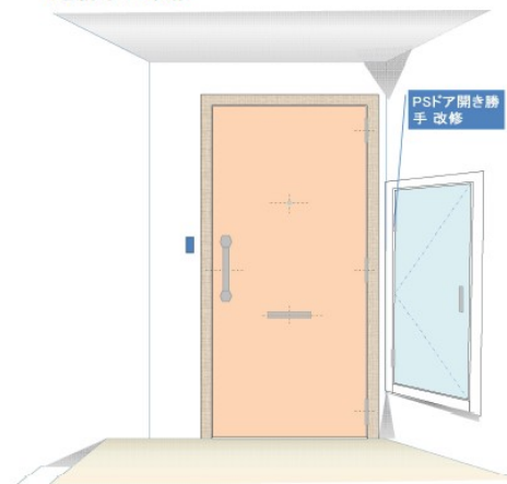
〈対策事例-1〉 パイプシャフトドアの吊元を逆勝手に改修
