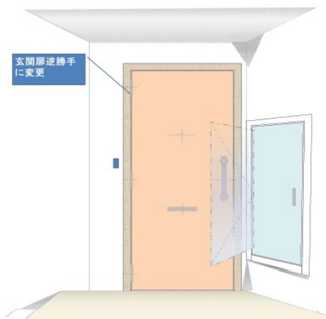
〈対策事例-2〉 玄関扉の勝手変更
