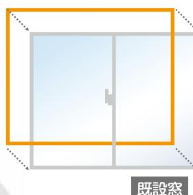
既設窓に内窓の枠を取り付け、
